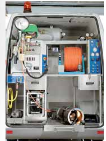
TV-Inspektionsanlage RCA proline mit SAT-Star Satellitenanlage (450 m Hauptkabel, 120 m Hausanschlusskabel), kombiniert mit dem Dichtheitsprüfsystem KAMPAC zur Prüfung von Muffen mit integrierter Kreis- und Schwenkkopfkamera von DN 200 bis DN 600 – wahlweise mit Luft oder Wasser. Pneumatisch betriebene Trommel mit 150 m Versorgungsleitung. Steuerleitungen und die Luftleitung sind in einem Kabel integriert. Rückraumausbau in Edelstahl und Aluminiumprofilen.
